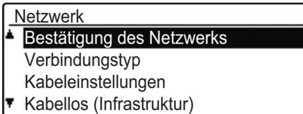
**Wählen Sie "Bestätigung des Netzwerks" mit der Taste [▼] oder [▲], und drücken Sie die Taste [OK].**
