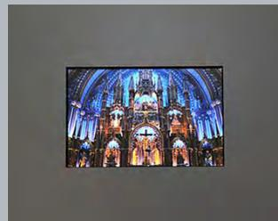
新IGZO液晶显示器(试产品)(上:6.1型 适用于元器件机器)(左:4.9型 适用于智能手机)
