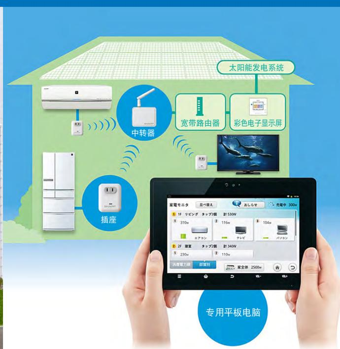
“电力可视化系统”JH-RTP1/JH-RTP2的示意图(面向日本市场),该系统可利用专用平板终端,实时确认每一个连接在插座上的家用电器的耗电量。
