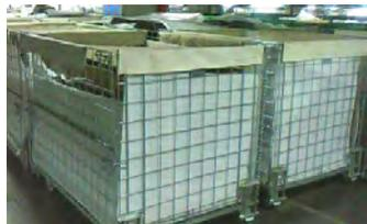
交付元件时使用的包装材料由瓦楞纸板变为金属制材料
